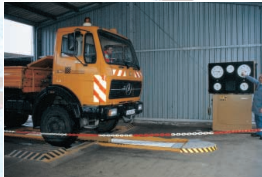
Die regelmäßige Prüfung der Bremsen erfolgt auf einem Rollen-Prüfstand. Gegen unbeabsichtigtes Betreten ist der Gefahrenbereich gesichert. ►
