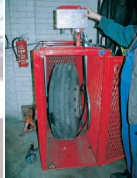
◀ Reifenbefüllkäfig mit automatischer Befüllereinrichtung (Tür für das Foto geöffnet).
