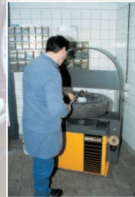
▲ Die Reifenauswuchtmaschine lässt sich nur in Betrieb setzen, wenn zuvor der Schutzbügel geschlossen wird.
