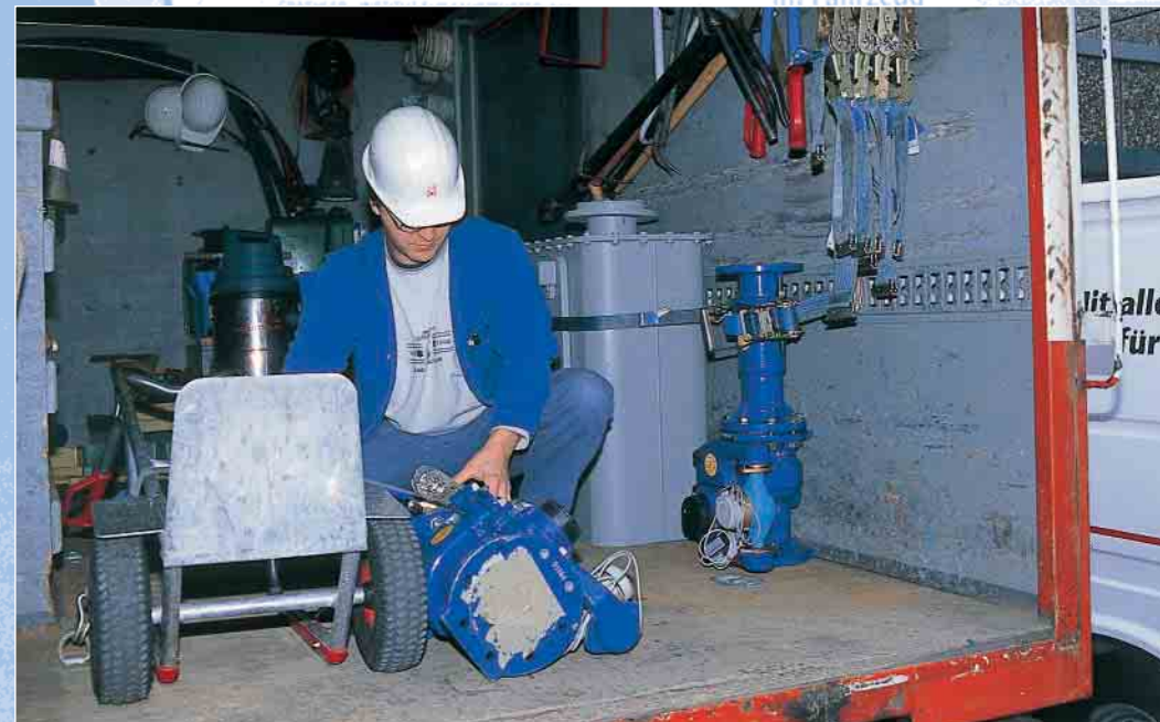
Schwere oder auch größere Stückgüter können im Fahrzeug an speziellen Anschlagpunkten, z. B. an den Seitenwänden, festgezurt werden. ▼
