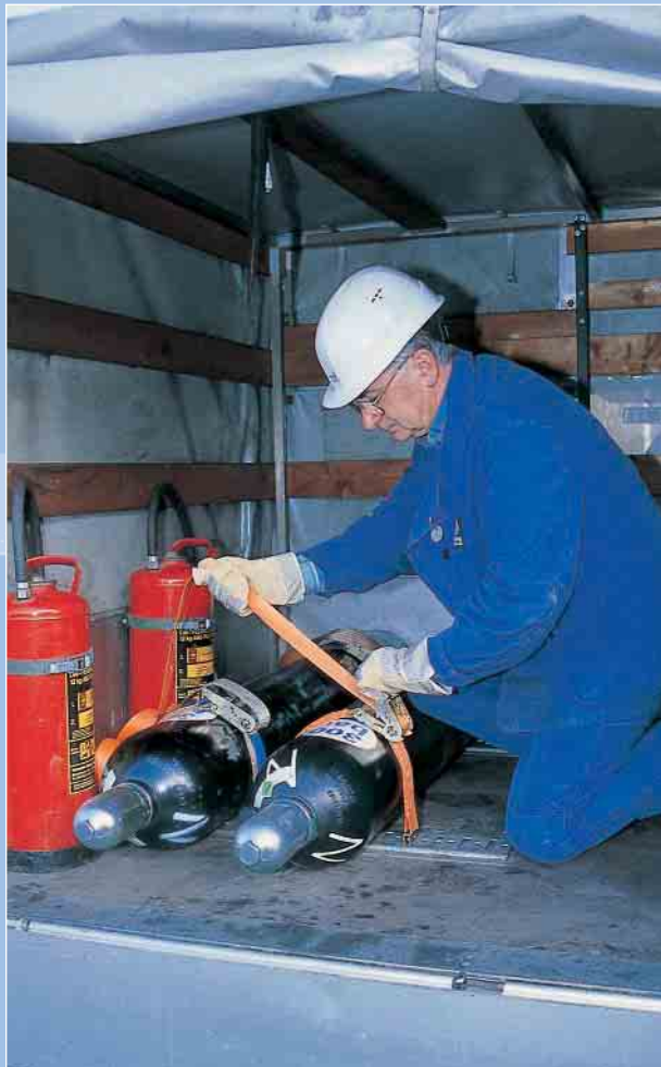
▲ Der Transport von Druckgasflaschen ist immer mit besonderen Risiken verbunden. Nur verschlossen und sicher auf dem Fahrzeug befestigt dürfen sie befördert werden.
