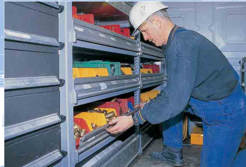
▲ Auch die verschiedenen Kleinteile im Werkstattfahrzeug müssen sicher aufbewahrt werden. Regale und Schubladenauszüge sind mit Sicherheitsverriegelungen ausgerüstet.
