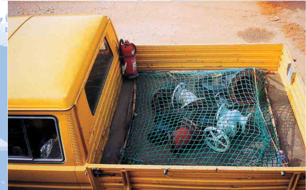
Ein geeignetes Sicherheitsnetz verhindert das Verschieben und Verrutschen mehrerer Gegenstände auf einer Ladepritsche. ▼
