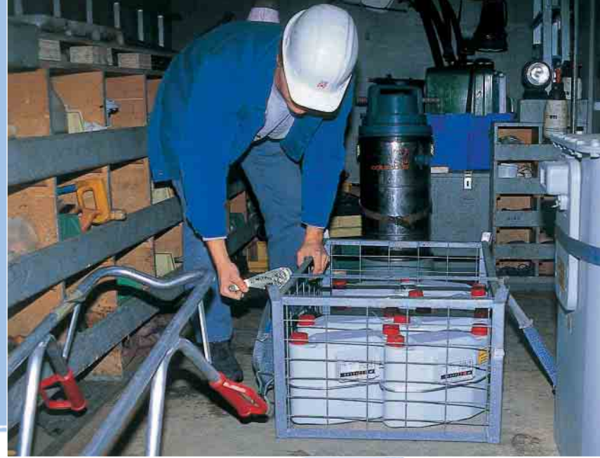
Müssen größere Stückzahlen kleinerer Teile transportiert werden, können diese z. B. in befestigten Drahtgitterboxen untergebracht werden. ▶
