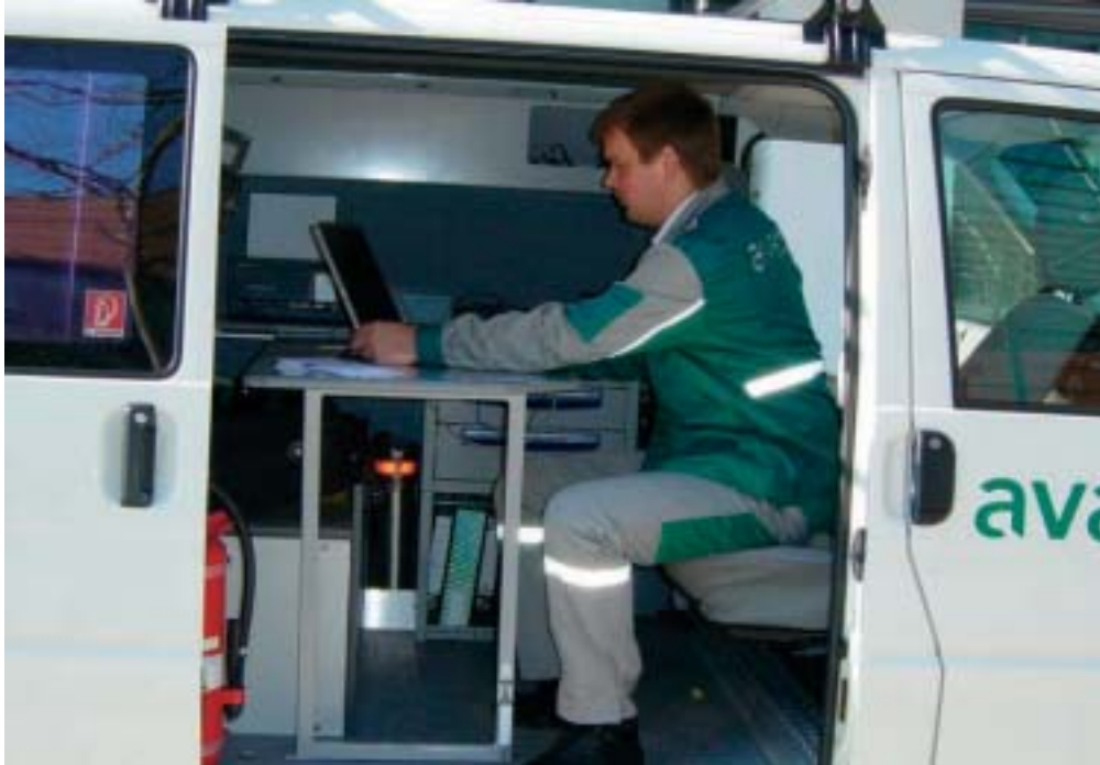
Büroarbeitsplatz im Netzmonteurfahrzeug mit Drehsitzvariante und Laptop
