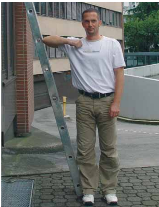
Bild 1: So lässt sich feststellen, ob eine Anlegeleiter im richtigen Winkel aufgestellt ist
