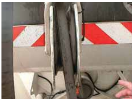
Schlauchführungsrolle vor dem Unfall ohne Schutzeinrichtung
