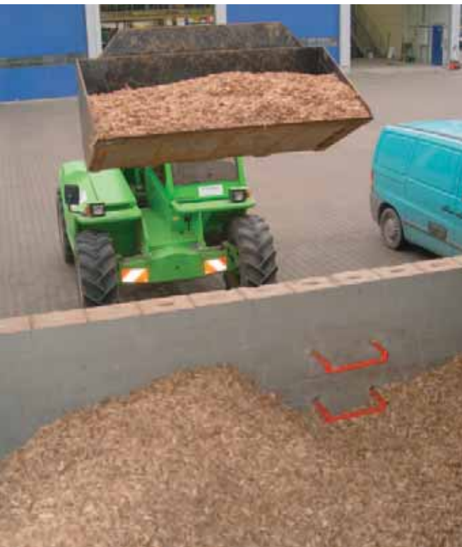
Muss ein Behälter begangen werden, wird von aussen eine Leiter eingehängt um einen sicheren Überstieg zum Steigeisengang zu schaffen.
