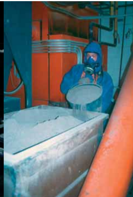
Offene Umfüllvorgänge, wie hier bei der Entsorgung von Zyklon- asche aus der Rauchgasreinigung, müssen vermieden werden.
