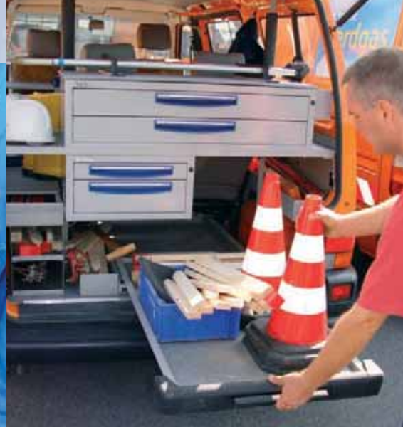
Feste Einbauten dienen der Ladungssicherung und sorgen für Ordnung im Fahrzeug. Die einzelnen Schubladen und herausziehbaren Staufächer sind im geschlossenen Zustand verriegelt.
