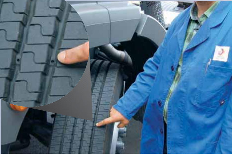
Der Reifenzustand ist regelmäßig zu prüfen. Die Abnutzung kann anhand der Kontrollmarkierungen ermittelt werden.
