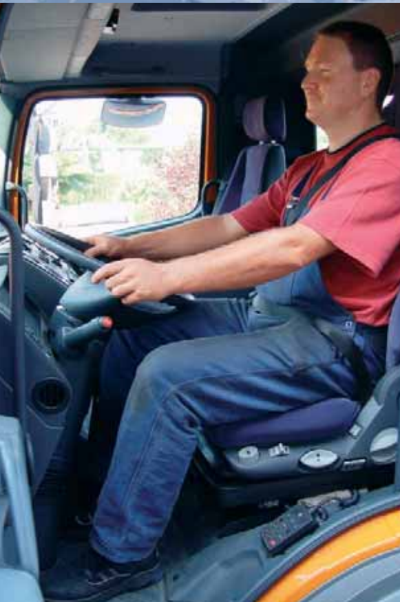
Eine ergonomisch günstige Sitzposition ist nur möglich, wenn der gesamte Fahrersitz in Längsrichtung, Sitzhöhe und Neigung verstellbar ist. Eine Unterstützung der Lendenwirbelsäule sollte ebenfalls vorhanden sein.
