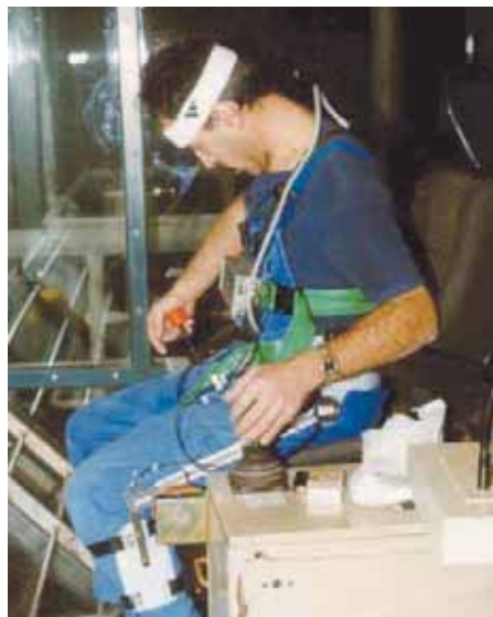
Cuela-Messsystem zur Erfassung von Körperhaltungen in Kranführerkabinen
