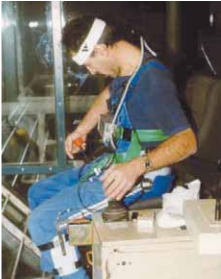
Cuela-Messsystem zur Erfassung von Körperhaltungen in Kranführerkabinen
