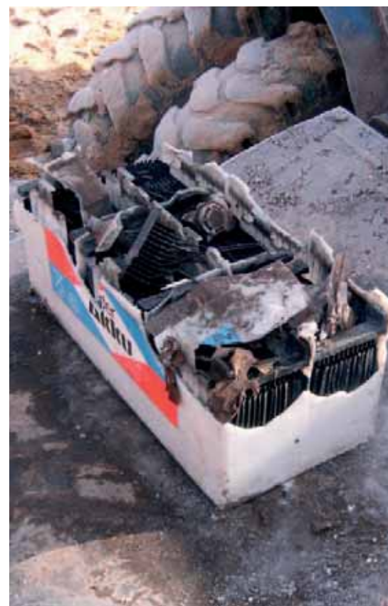
Durch Knallgas geborstene Batterie.
