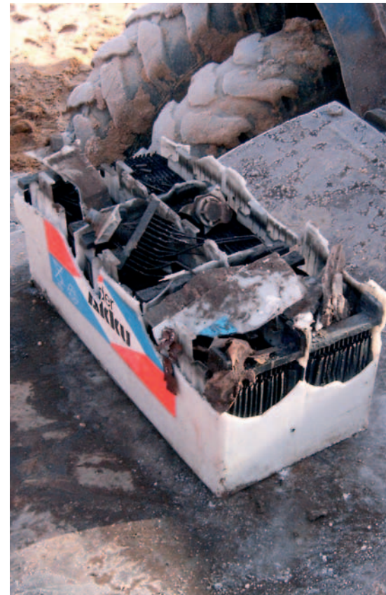
Durch Knallgas geborstene Batterie.
