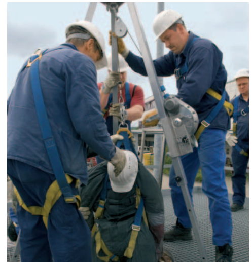
Aus dem Schacht wird die Übungspuppe mittels der Rettungshubeinrichtung des Höhensicherungsgerätes geborgen.
