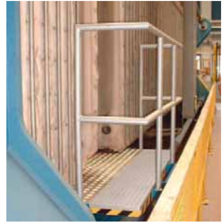
Rückseite der betriebsbereiten Bühne mit eingesteckten Geländern.
