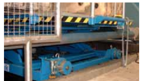
Fahrwerk der Hubarbeitsbühne und elektrohydraulische Scherenkonstruktion.
