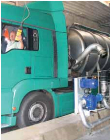
Durch die Fernbedienung hat der LKW-Fahrer keinen Kontakt mit gülleführenden Armaturen.
